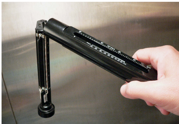
Uso de un psicómetro de eslinga para medir la humedad relativa del aire
