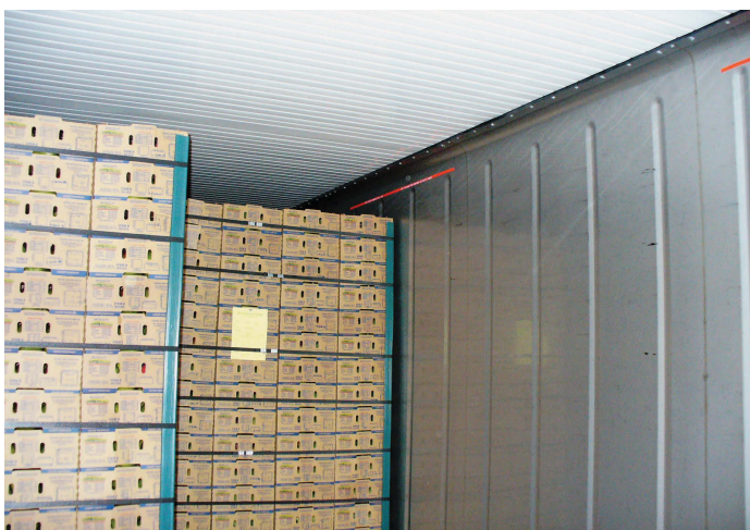
Interior de un contenedor en el que se muestra como es cargado, no sobrepasando la línea roja de carga
