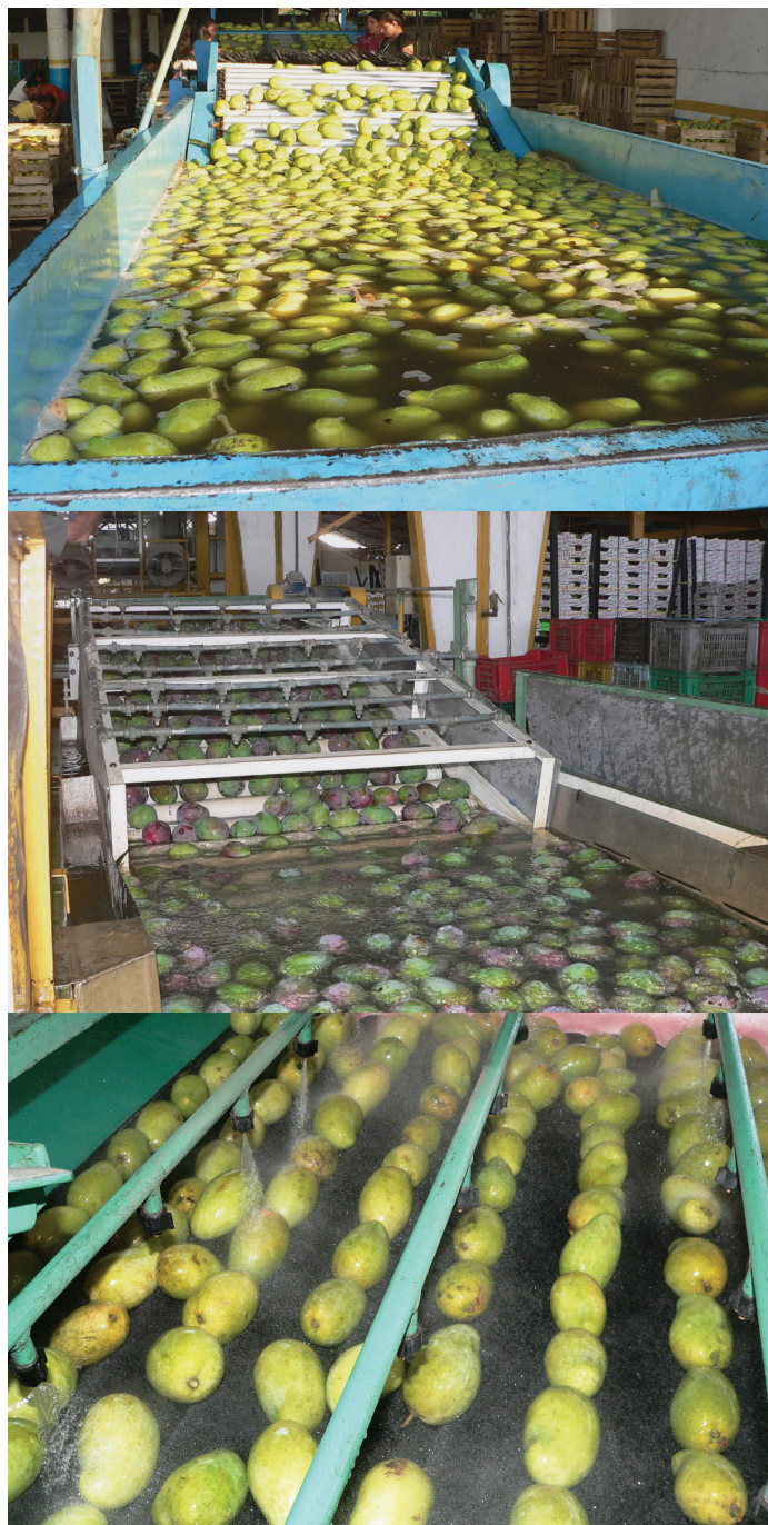
Lavado inicial de frutas usando un tanque de inmersión (foto superior), esprayado (foto intermedia), y mangos en banda de cepillado de frutos (foto inferior)
