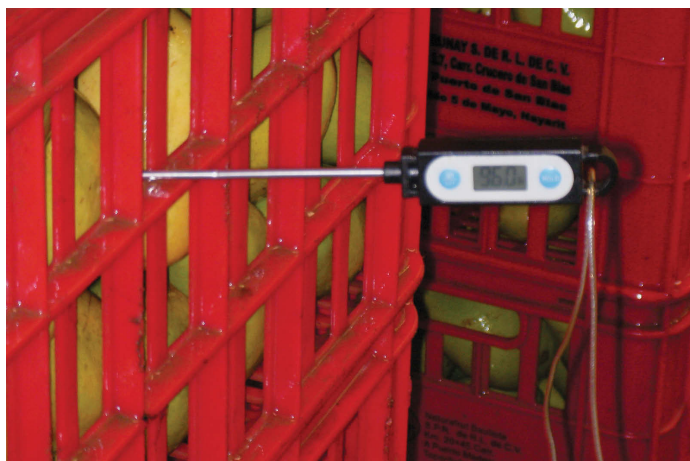
Medición de la temperatura de la pulpa de mango seguido al tratamiento de enfriamiento de frutos con agua helada
