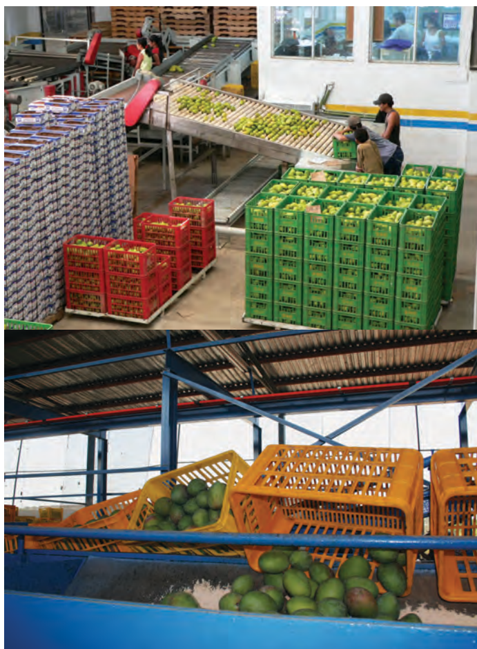
Descarregamento manual (alto) e automatizado (abaixo) de mangas na linha de classificação
