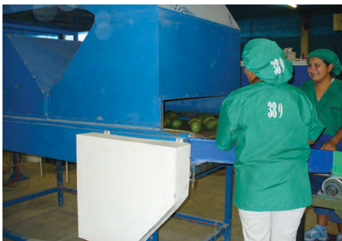
Mangas entrando numa câmara de aplicação de cera
