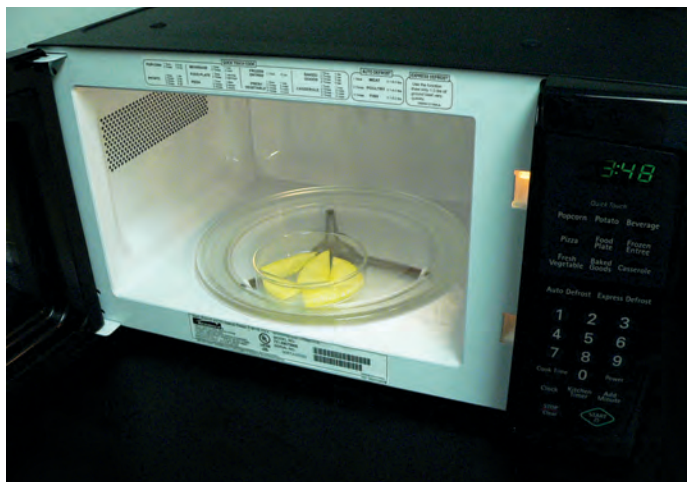
Usando um forno de micro-ondas para medir o teor de matéria seca da manga
