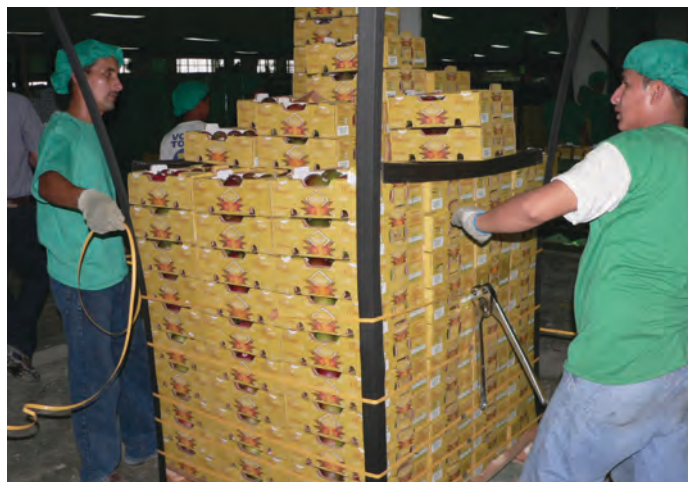
Cantoneira e fitas de arqueação sendo aplicadas a um palete
