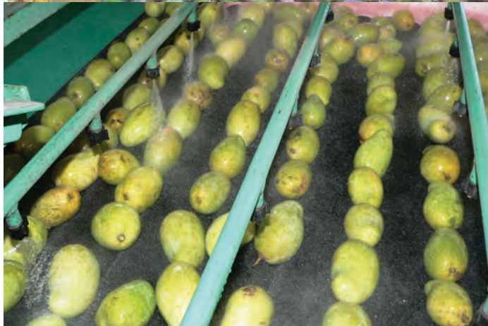
Lavagem inicial das frutas por imersão no tanque (alto), por aspersor (meio), e numa mesa para escovação (abaixo)
